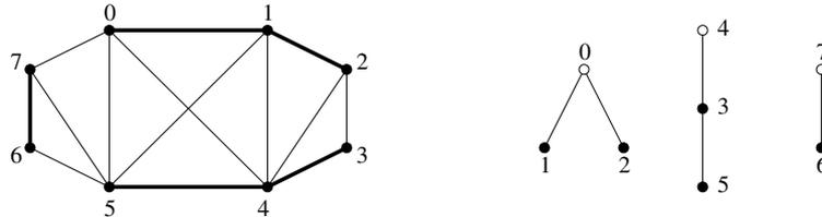
Figure 6: Un ensemble d'arbres enracinés associé aux composantes connexes de  $T$  pendant l'algorithme (les arêtes de  $T$  sont en gras). Le seul lien entre une composante de  $T$  et l'arbre enraciné associé est qu'ils partagent le même ensemble de sommets.
