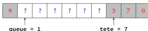
Une conséquence de ce choix est que l'égalité `tete = queue` ne permet pas de distinguer entre la file vide et la file pleine ; pour palier à ce problème, on s'interdit de remplir complètement le tableau : ainsi, on décrète qu'une file qui contient  $n - 1$  éléments est pleine, situation caractérisée par l'égalité :  $(queue + 1) \bmod n = tete$ .
