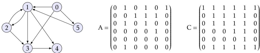
FIGURE 1 – Un graphe orienté, sa matrice d'adjacence et la matrice des sommets accessibles.
